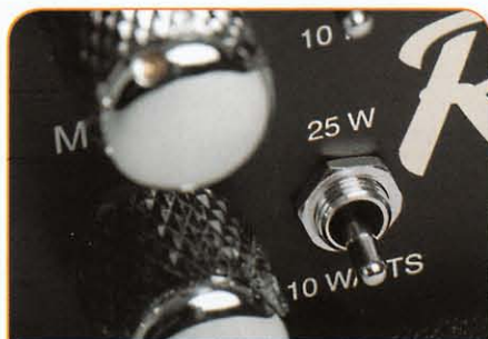
Wybór 25 lub 10 W ma znaczenie dla finalnego brzmienia wzmacniacza. Przy 25 W otrzymujemy większy headroom, natomiast przy 10 W lampy mocy szybciej się przesterowują.
